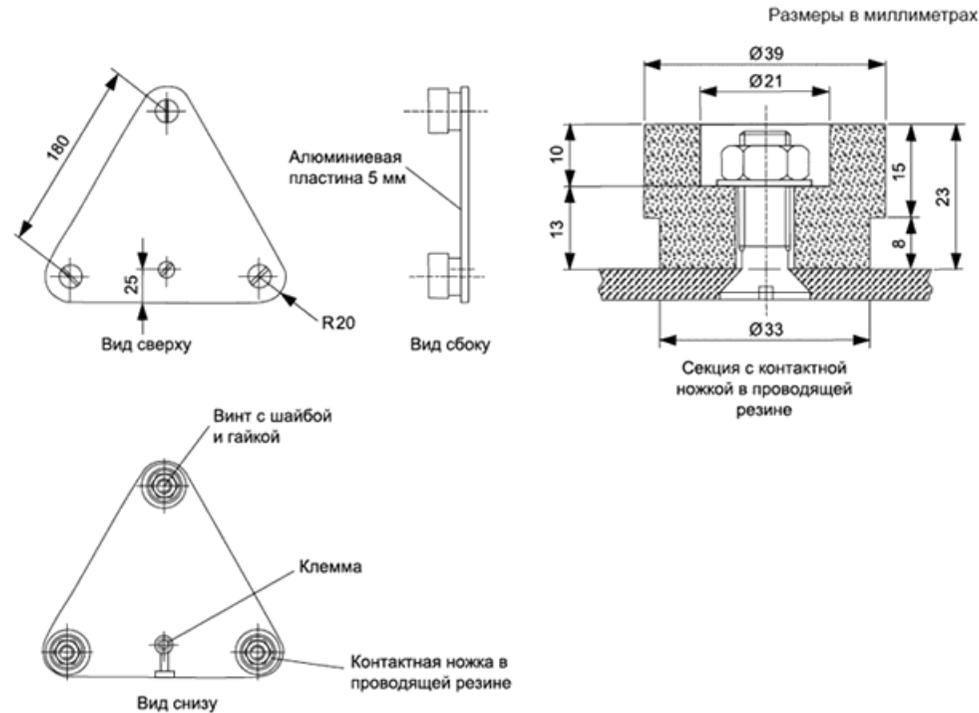
Рисунок В.1 - Испытательный электрод 1
