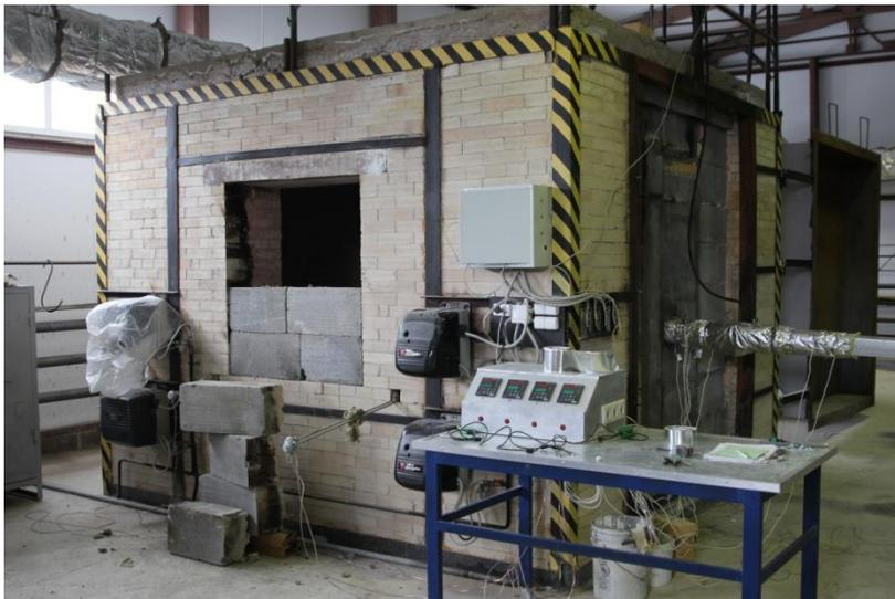
*Комплексная установка для испытаний на огнестойкость конструкций и оборудования инженерных систем зданий и сооружений, ГОСТ Р 53299-2013, ГОСТ Р 53303-2009, ГОСТ Р 53302-2009, ГОСТ Р 53304-2009, ГОСТ Р 53301-2013*
