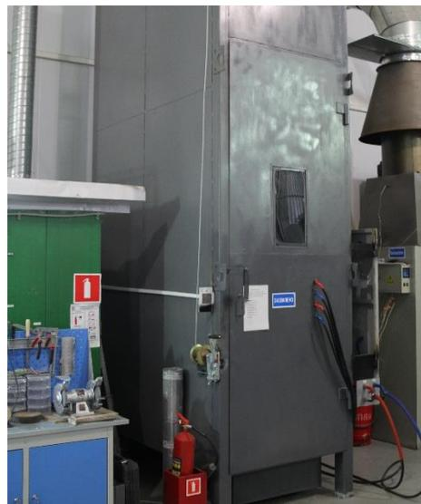
*Установка для испытания кабелей, проложенных в пучке (при групповой прокладке) на нераспространение горения, ГОСТ IEC 60332-3-21-2011, ГОСТ IEC 60332-3-22-2011, ГОСТ IEC 60332-3-23-2011, ГОСТ IEC 60332-3-24-2011, ГОСТ IEC 60332-3-25-2011*
