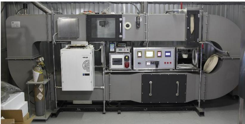
*Стенд для испытаний извещателей пожарных дымовых оптико-электронных, тепловых, газовых и комбинированных (дымовойтепловой-газовый канал)
