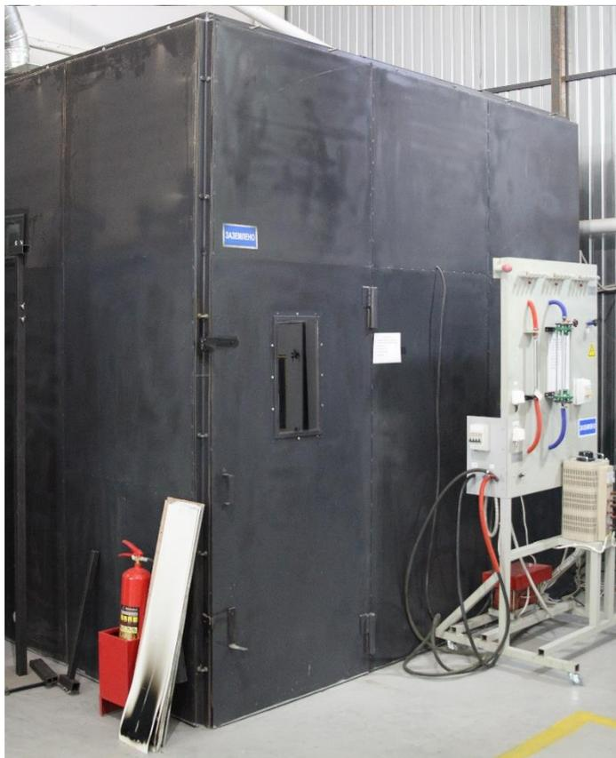
Установка для измерения плотности дыма при горения кабелей в заданных условиях . (Метод определения плотности дыма твердых веществ и материалов по ГОСТ 12.1.044-89)
