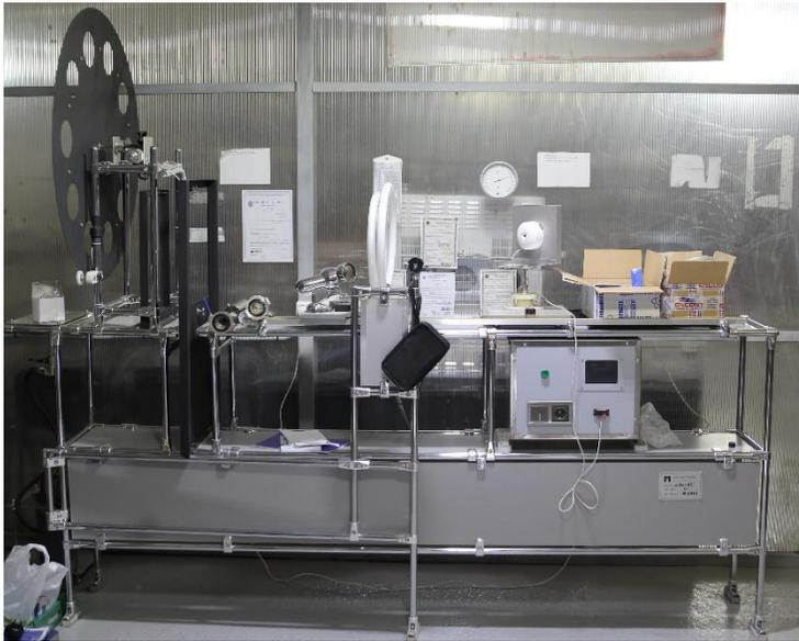
Стенд для испытаний извещателей пожарных
