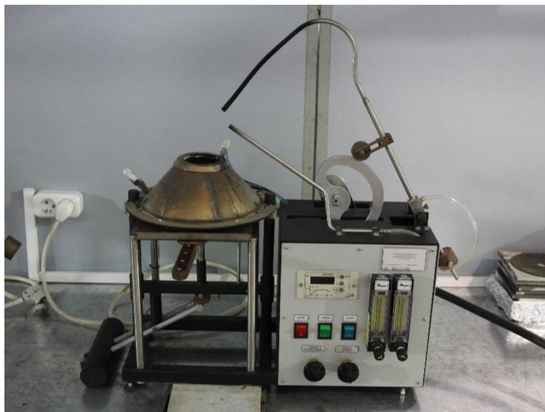
*Установка для определения воспламеняемости строительных материалов ГОСТ 30402-96*
