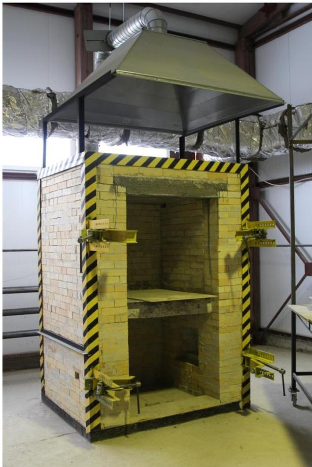
Данная печь предназначена для проведения испытаний на огнестойкость несущих, самонесущих и навесных стен и перегородок, покрытий и перекрытий, а также других несущих и ограждающих конструкций, дверей, люков и ворот, предназначенных для заполнения проемов в стенах, перегородках и перекрытиях, а также дверей шахт лифтов.
