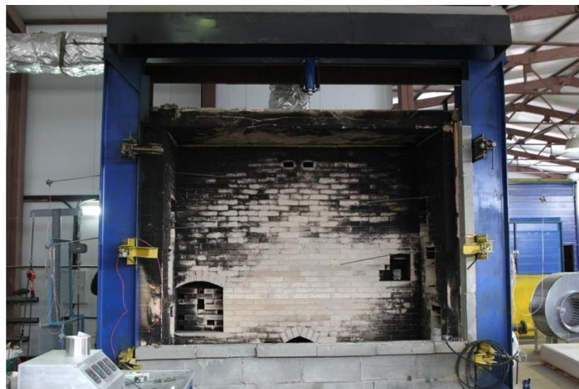
*Установка для определения огнестойкости вертикальных строительных конструкций, ГОСТ Р 53303-2009, ГОСТ Р 53307-2009, ГОСТ Р 53308-2009, ГОСТ 30247.0-94, ГОСТ 30247.1-94, ГОСТ 30247.3-2002*
