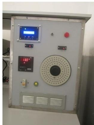
Установка (стенд) для проведения функциональных испытаний, испытаний по устойчивости к изменению напряжений питания, испытаний по электробезопасности и пожарной безопасности приборов приемно-контрольных пожарных, охранно-пожарных, приборов управления пожарных, источников 1-й категории электроснабжения, модулей (компонентов приборов, в т.ч. устройств пусковых и сигнально-пусковых)
