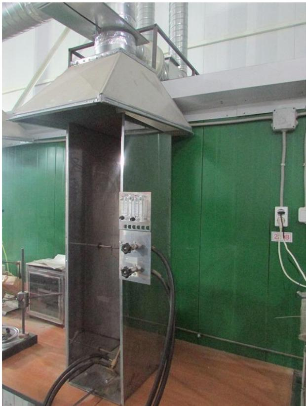
Установка экспериментального определения не распространения горения кабелей проложенных в пучках (Пучок) (Метод определения не распространения горения кабелей проложенных в пучках Метод определения стойкости распространения горения при групповой прокладке по ГОСТ Р МЭК 60332-3-10).
