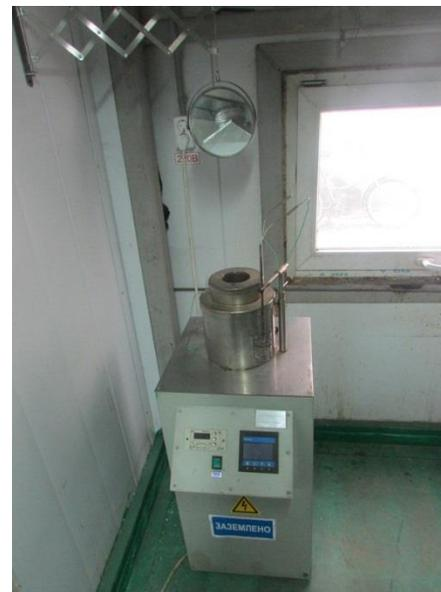
*Установка для испытания строительных материалов на негорючесть ГОСТ 30244-94 метод 1*
