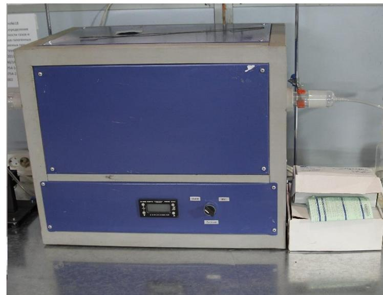
Установка для определения степени кислотности газов и количества газов галогенных кислот, выделяемых при горении конструкции кабелей (ГОСТ IEC 60754-1- 2011)
