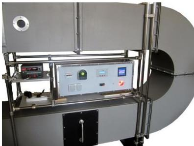
Установка (стенд) для проведения функциональных испытаний, испытаний по устойчивости к повышенной температуре и изменению напряжений питания извещателей пожарных газовых точечных.
