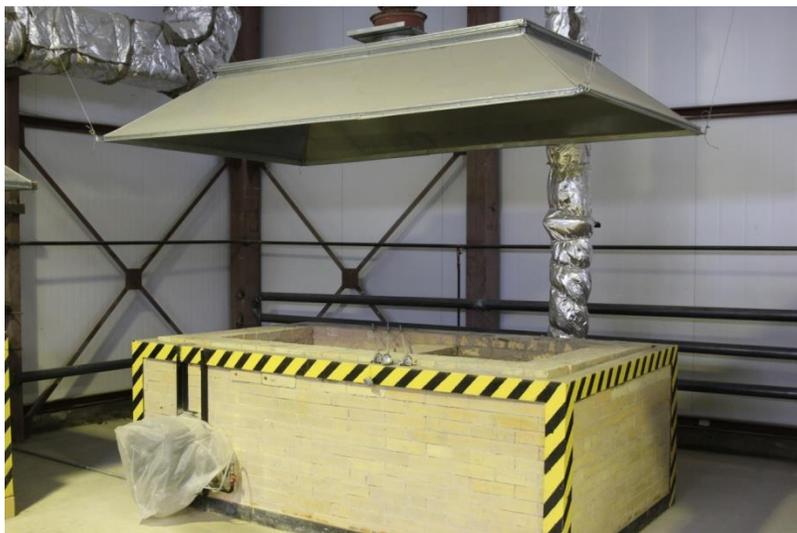
*Установка для определения класса пожарной опасности горизонтальных конструкций ГОСТ 30403-2012*
