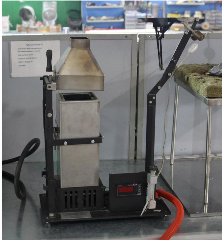
Универсальная установка для определения группы трудногорючих материалов и огнезащитных свойств покрытий и пропиточных составов для обработки древесины "Керамическая труба" (Метод определения группы трудногорючих и горючих твердых неметаллических веществ и материалов в воздушной среде по ГОСТ 12.1.044-89;
