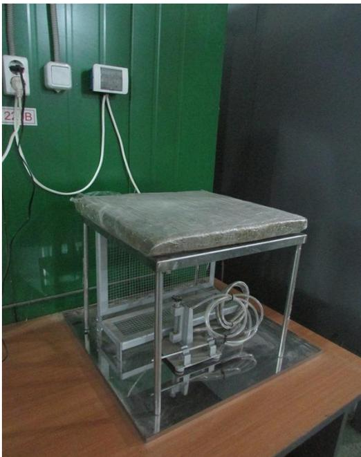
*Установка для определения воспламеняемости элементов мягкой мебели и постельных принадлежностей, ГОСТ Р 53294-2009*
