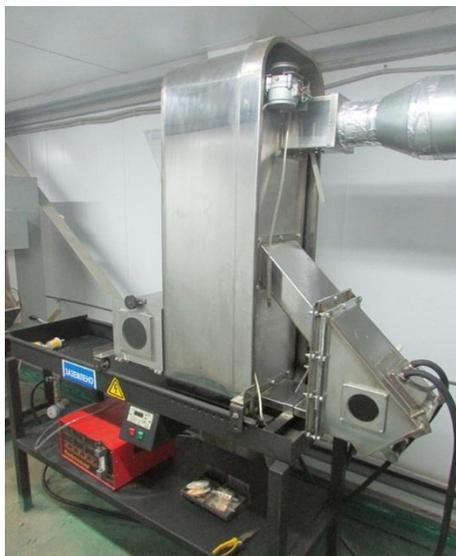
*Установка определения показателя токсичности продуктов горения полимерных материалов ГОСТ 12.1.044-89*
