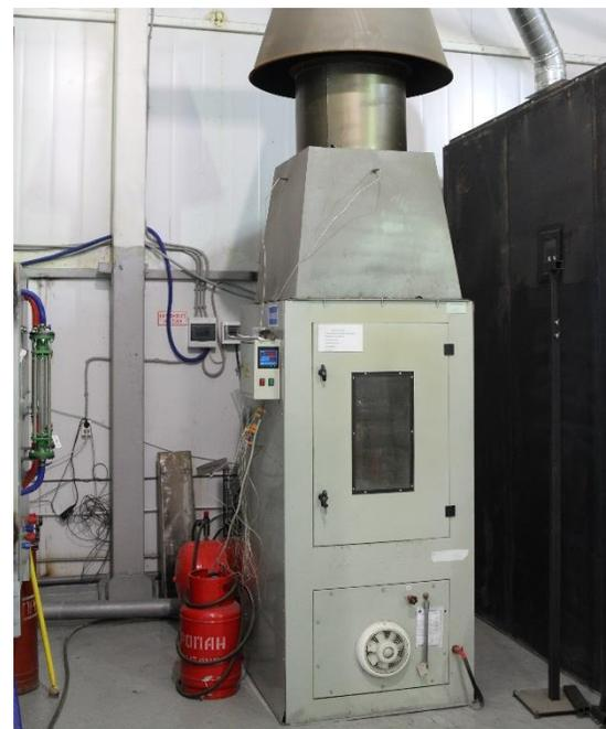
*Установка для испытания строительных материалов на горючесть ГОСТ 30244-94 метод 2*
