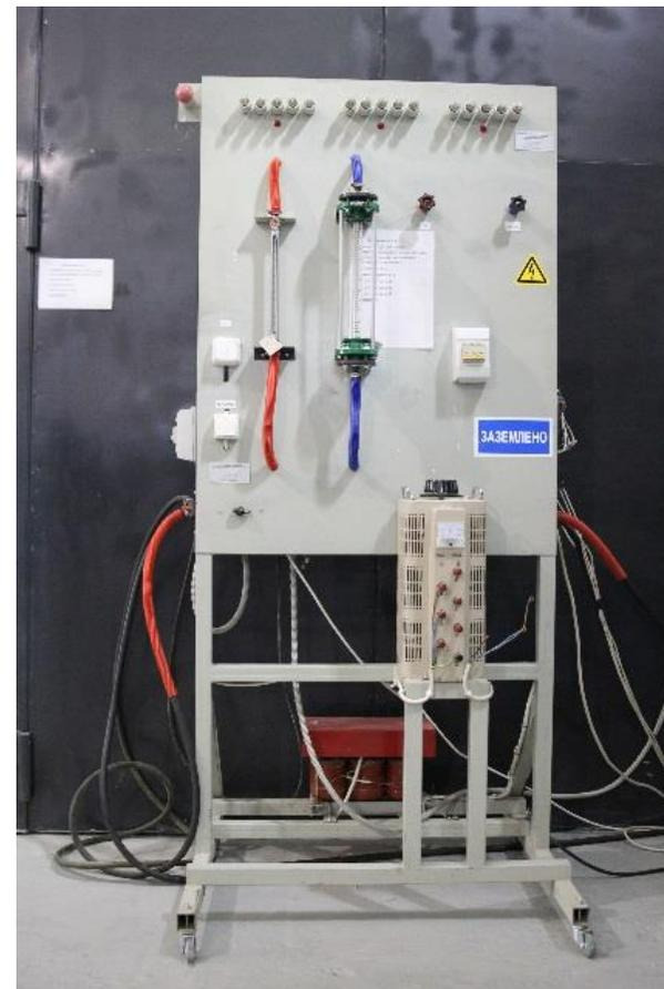
*Установка для измерения плотности
