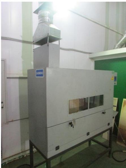
*Установка для испытаний на распространение пламени по поверхности покрытий полов, кровель ГОСТ Р 51032-97*
